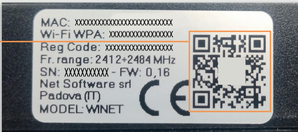
**N.B.** - E' possibile effettuare la connessione manuale dello smartphone alla centralina ricercando la rete wi-fi "RELAYS-XXXXXXX", cliccando su essa ed inserendo la password riportata nell'etichetta apposta sulla centralina alla voce "WIFI WPA".
